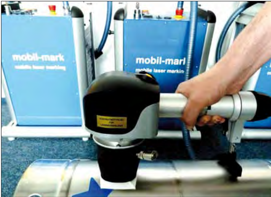
▲ Der Beschriftungskopf kann auch per Hand geführt werden, wie das Beispiel der Fassbeschriftung zeigt.
