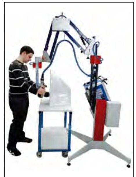
▲ Zur Sanitärbeschriftung wird der Beschriftungskopf auf eine Kranvorrichtung montiert.
