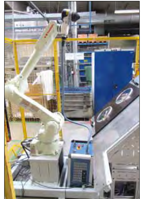
▲ Zur serienmäßigen Beschriftung von Kochtopfböden wird der Beschriftungskopf auf einen Roboterarm montiert.
