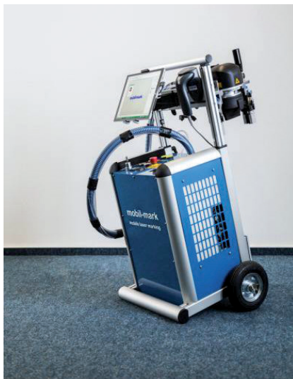
Bild 2: Das kompakte Handteil des Markiersystems lässt sich auch an schwer zugänglichen Stellen verwenden.
