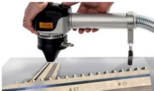
Die MTU Aero Engines AG kennzeichnet kältebehandelte Spezialwerkzeuge für den Triebwerksbau von Flugzeugen mittels des universell einsetzbaren Gravurlasers des deutschen Industrielaser-Spezialisten Mobil-Mark. Bild: Mobil-Mark
